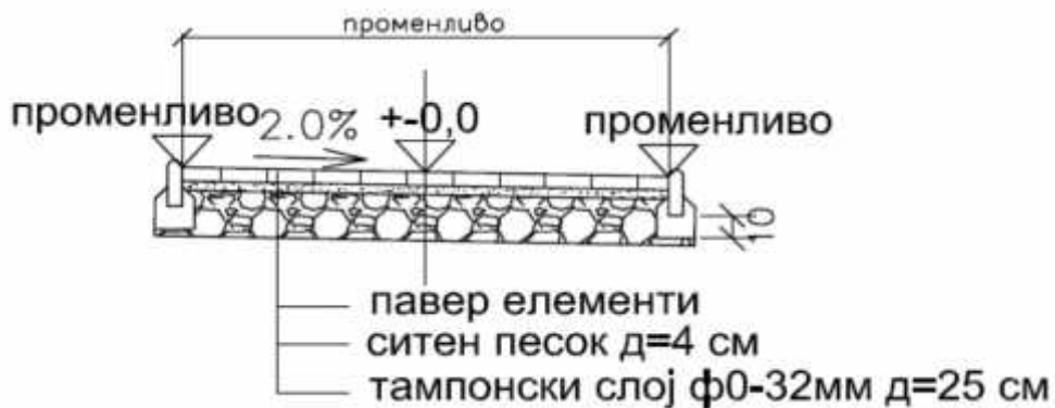
Foto 12 Përfaqësimi skematik i elementëve të betonit
