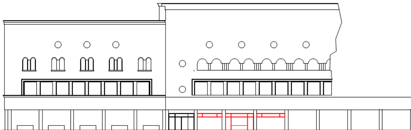
Слика 13 Постојна состојба јужна фасада (со црвена боја се означени локациите за демонтажа)
