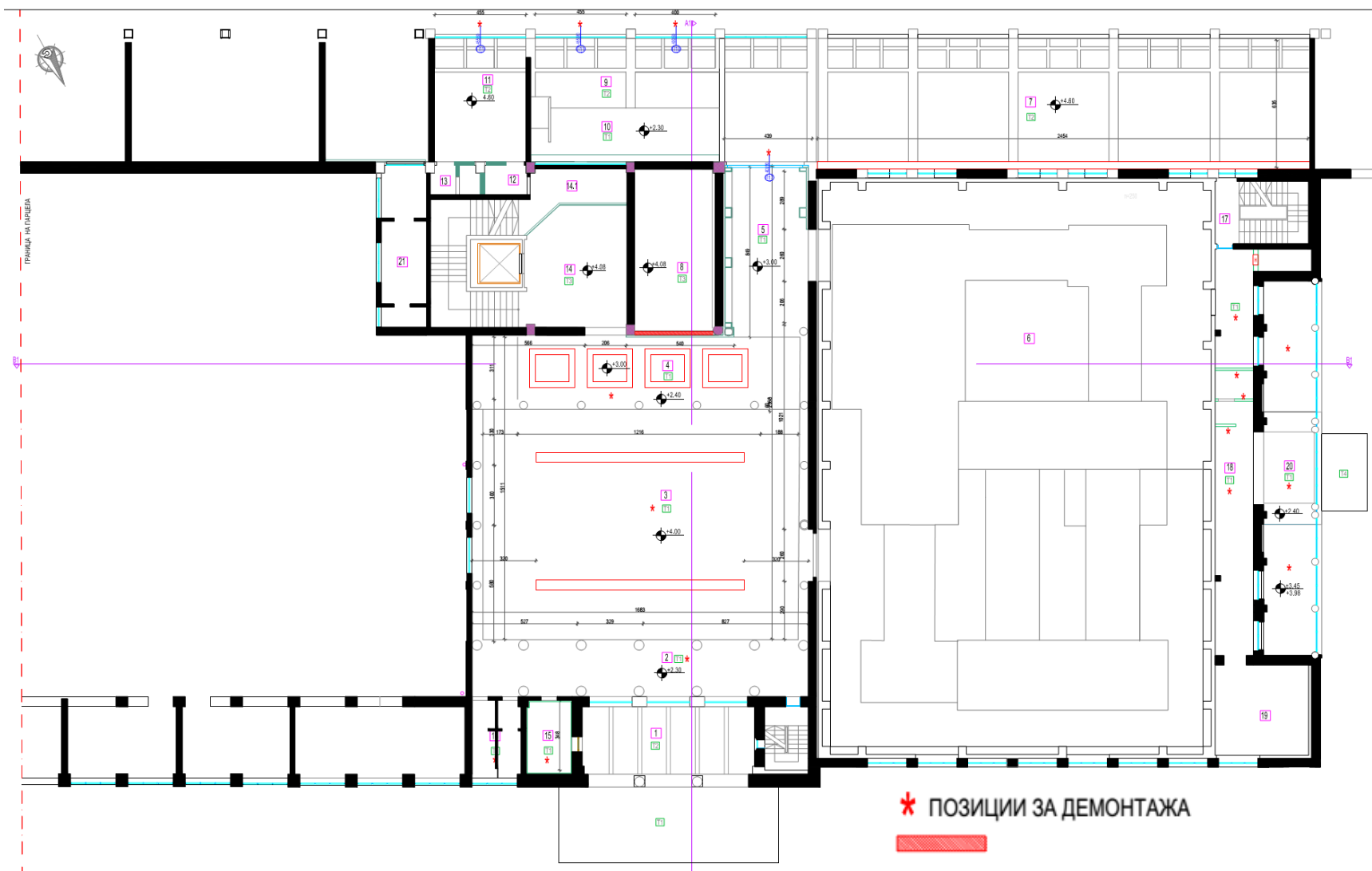
Слика 4 Основа на таван на приземјето (постојна состојба) со означени локации за демонтажа
